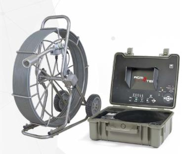
La Tubicam® XL est un modèle dédié à l'inspection des réseaux publics et V.R.D. La rigidité de son jonc vidéo et le diamètre de sa tête de caméra vous permettront de visualiser les réseaux du Ø60 mm au Ø400 mm de diamètre, sur une longueur de 60 ou 120 mètres.
